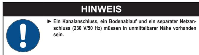
Wenn kein Bodenablauf vorhanden ist, kann die Schutzfunktion des in der Trinkwasserbehandlungsanlage integrierten AQA Stops (je nach Modell vorhanden) oder der internen AQA Stop Funktion ausreichend sein. Dies liegt jedoch im Ermessensspielraum des Sachversicherers. Die Klärung obliegt dem Anlagenbetreiber.
